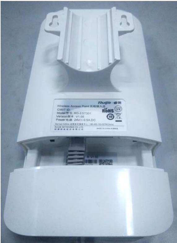
图 3-6 设备 LAN1/POE 口、LAN2 均插入网线并盖上市后盖
